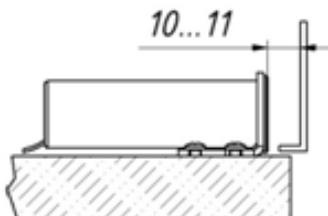
Установить замок на неподвижной поверхности. Расстояние от внутренней поверхности закрытой дверцы до гайки замка должно быть 10-11 мм, что гарантирует необходимый свободный ход дверцы в диапазоне 3-4 мм при закрытом замке. Подключите замок в соответствии с п. 6.2.
