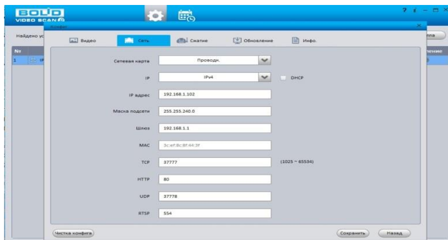
Рисунок 8.2 Изменение IP-адреса с помощью утилиты «BOLID VideoScan»
