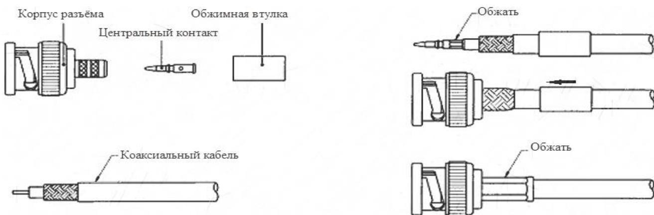
Рисунок 3.10 Схема обжима BNC
