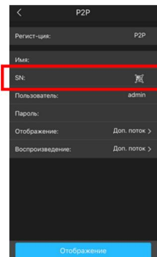
Рисунок 7.7 Сканирование QR-кода устройства в мобильном приложении
