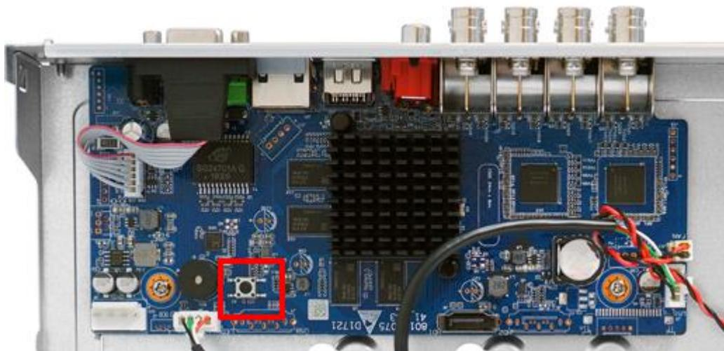
Рисунок 6.124 Возможный пример нахождения кнопки сброса
