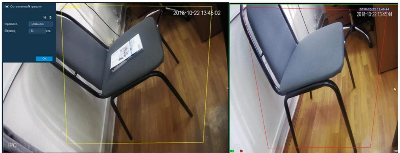
Рисунок 6.51 «Пропавший предмет» до и после срабатывания
