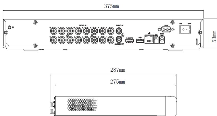
Рисунок 3.9 Габаритные размеры видеорегистратора
