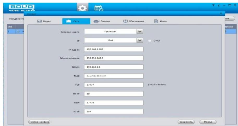
Рисунок 8.2 Изменение IP-адреса с помощью утилиты «BOLID VideoScan»
