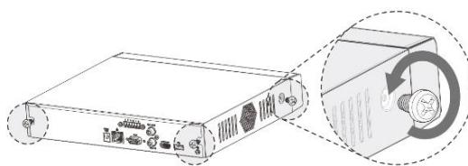
Рисунок 3.3 Установка жесткого диска
