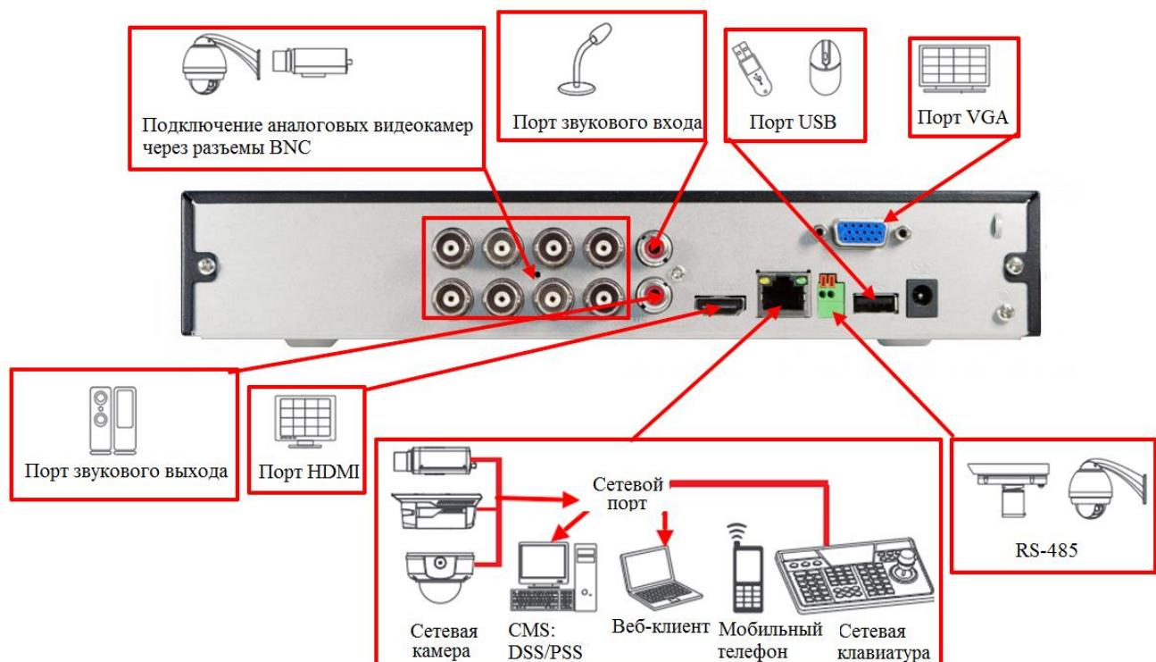
Рисунок 3.2 Внешний вид задней панели
