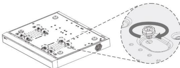
Рисунок 3.6 Установка жесткого диска
