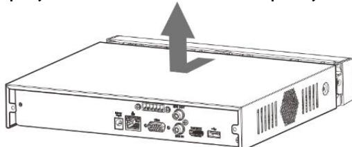
Рисунок 3.4 Установка жесткого диска
