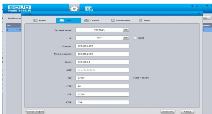
Рисунок 10.2 Изменение IP-адреса с помощью утилиты «BOLID VideoScan»
