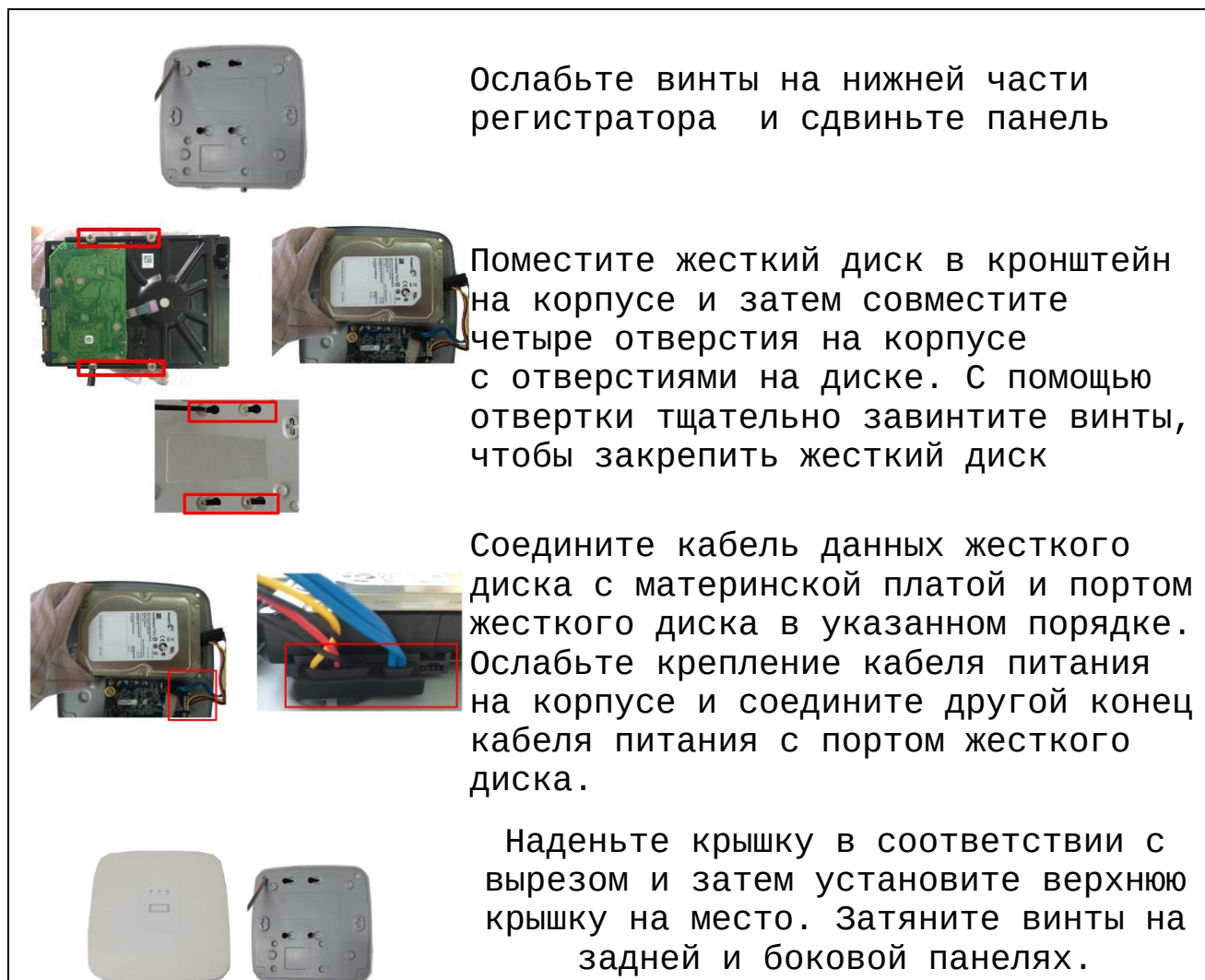
Рисунок 5.2 Порядок установки жесткого диска
