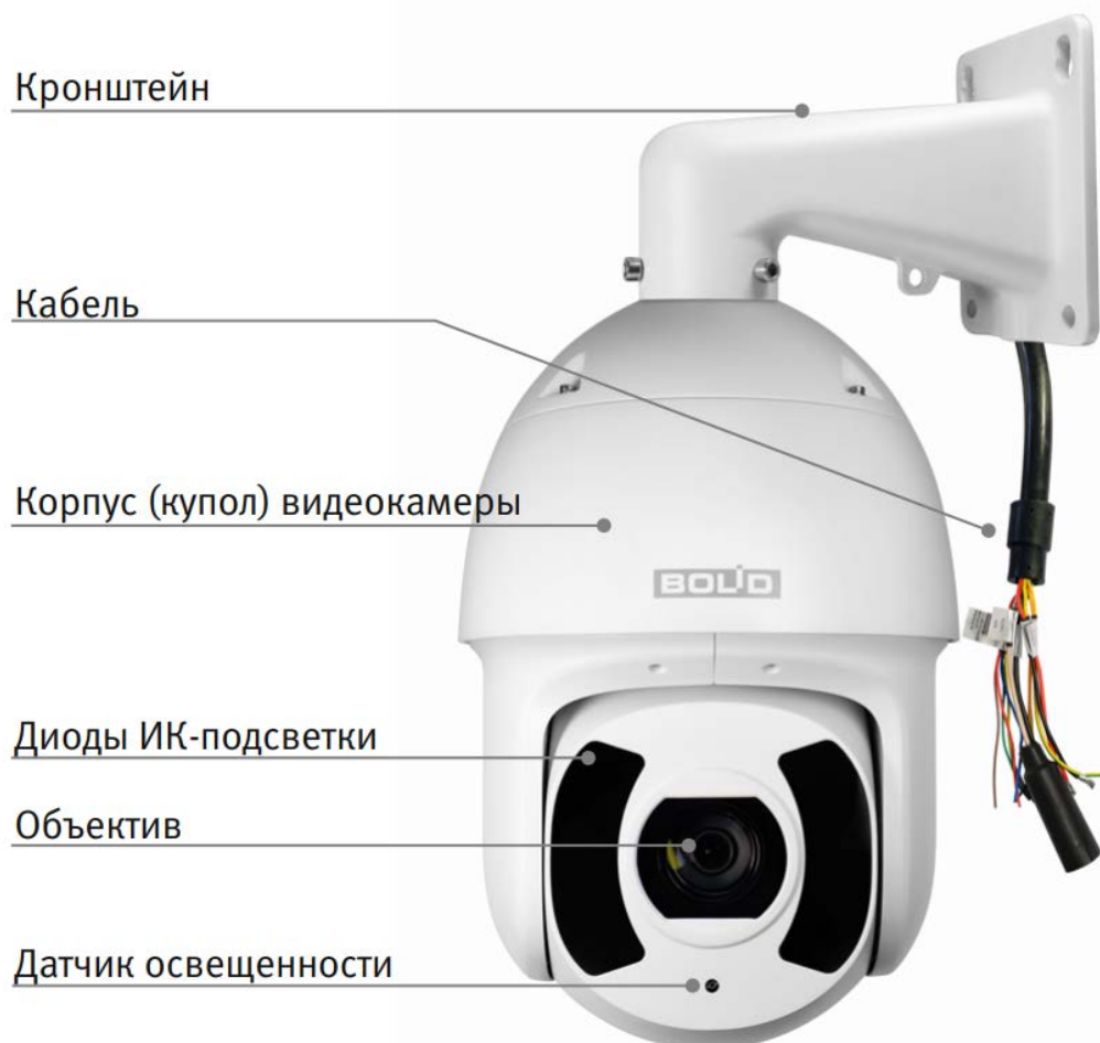
Рисунок 4.1 — Внешний вид и основные элементы видеокамеры
