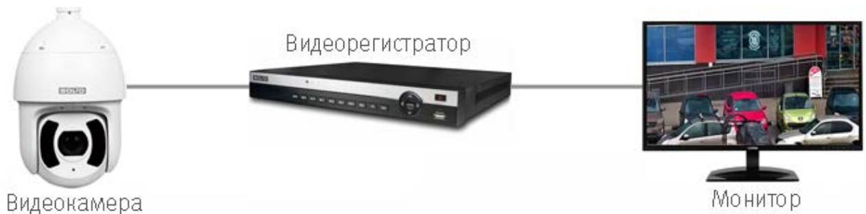
Рисунок 6.2 — Схема подключения видеокамеры
