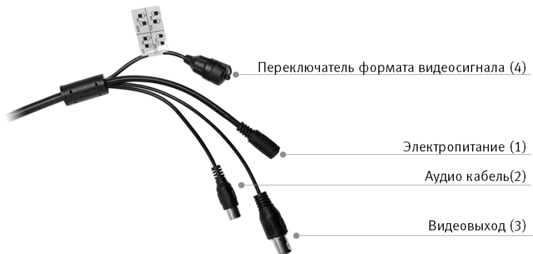
Рисунок 6.1 — Концевая раскладка кабеля видеокamеры
