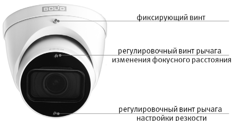
Рисунок 6.4 — Настройка фокусного расстояния и направления объектива
