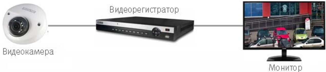
Рисунок 6.2 — Схема подключения видеокамеры
