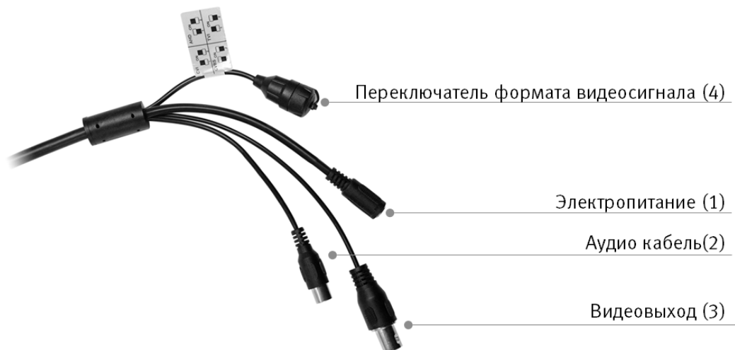
Рисунок 6.1 — Концевая раскладка кабеля видеокamеры
