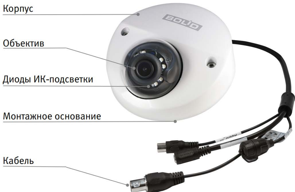
Рисунок 4.1 — Внешний вид и основные элементы видеокамеры
