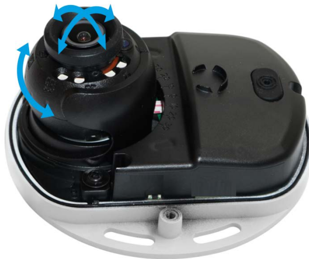
Рисунок 6.4 — Настройка направления объектива
