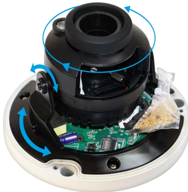
Рисунок 6.5 — Настройка направления объектива
