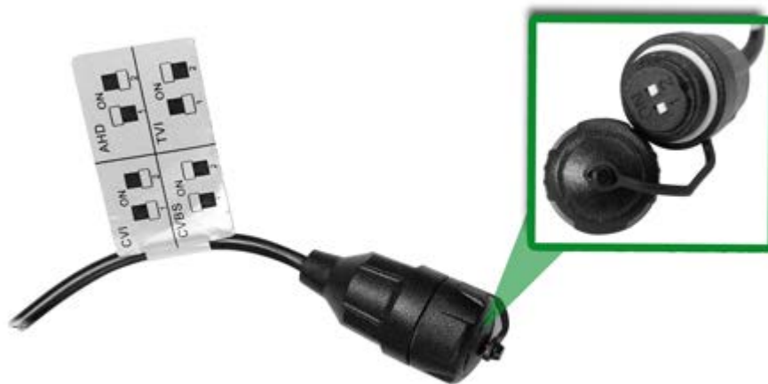
Рисунок 6.3 — Переключатель формата видеосигнала
