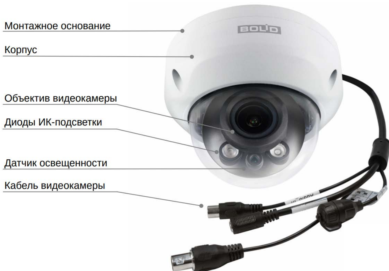
Рисунок 4.1 — Внешний вид и основные элементы видеокамеры
