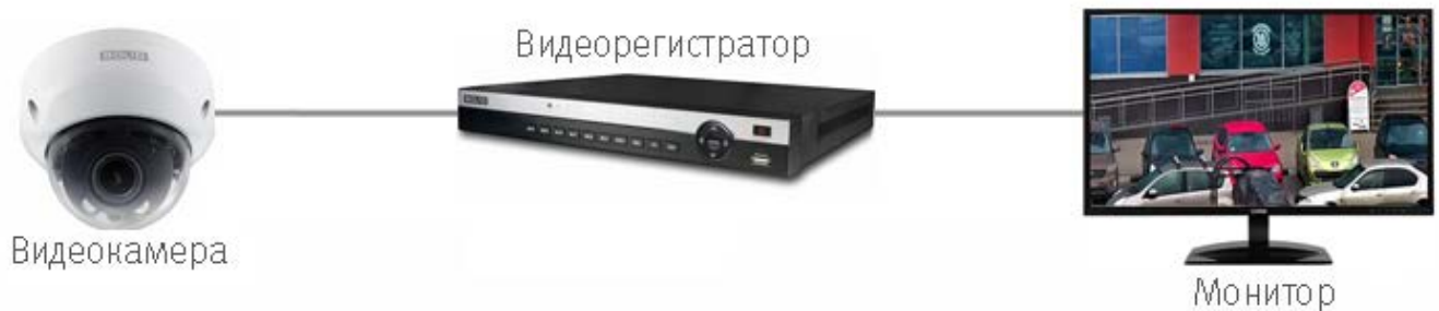
Рисунок 6.2 — Схема подключения видеокамеры
