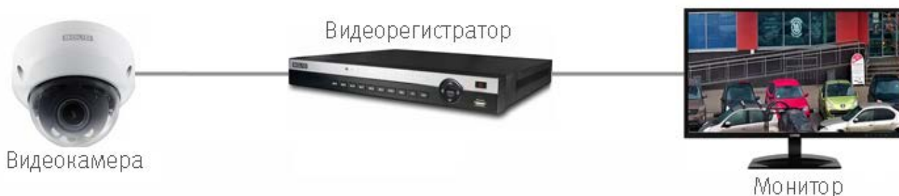
Рисунок 6.2 — Схема подключения видеокамеры
