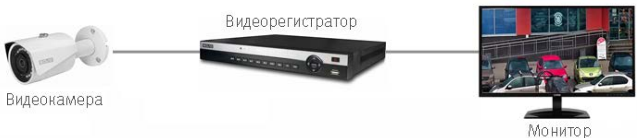
Рисунок 6.2 — Схема подключения видеокамеры
