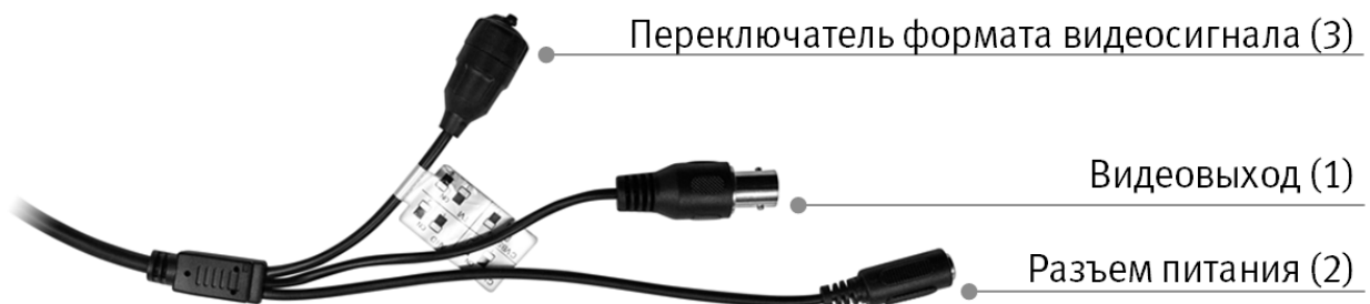
Рисунок 6.1 — Концевая раскладка кабеля видеокamеры
