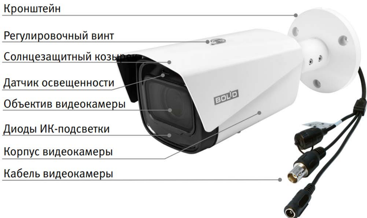
Рисунок 4.1 — Внешний вид и основные элементы видеокамеры
