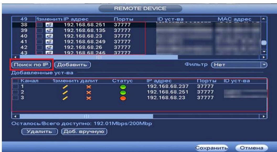
Рисунок 7.31 Настройка добавления камер по поиску в сети.
