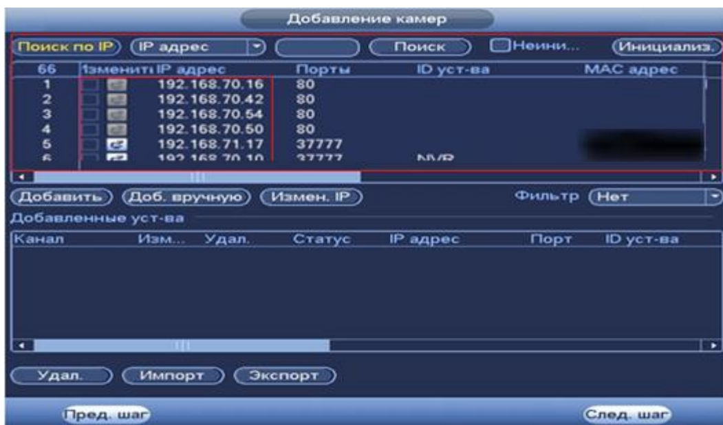
Рисунок 6.10 Настройка добавления камер по поиску в сети.
