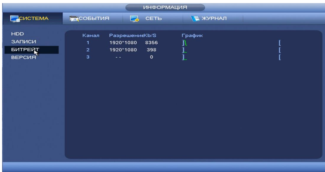
Рисунок 8.20 Интерфейс просмотра битрейта
