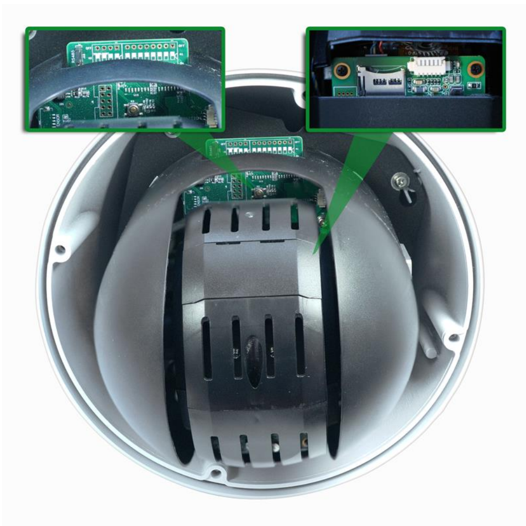
Рисунок 4.2 – Расположение кнопки аппаратного сброса и слота для карты памяти «Micro SD»
