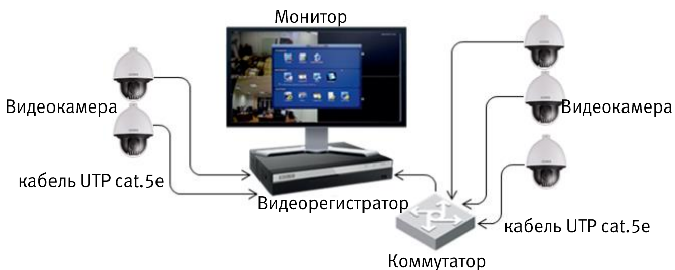
Рисунок 6.4 – Схема подключения видеокамеры к видеорегистратору
