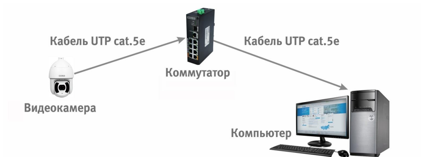
Рисунок 6.3 – Схема подключения видеокамеры к компьютеру через коммутатор
