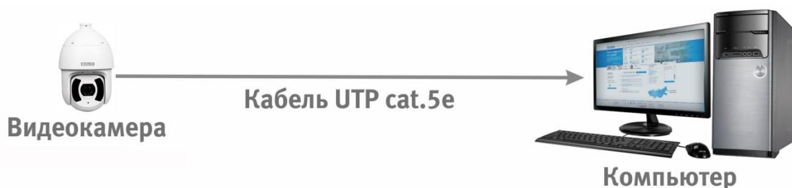
Рисунок 6.2 – Схема подключения видеокamеры к компьютеру
