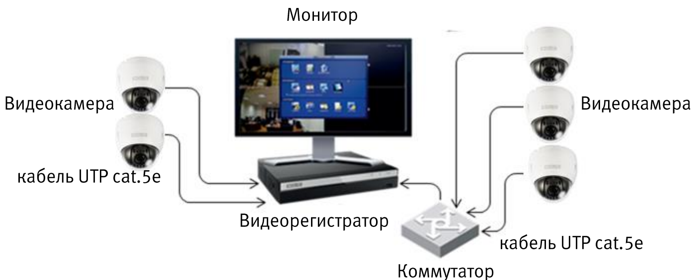
Рисунок 6.4 – Схема подключения видеокамеры к видеорегистратору
