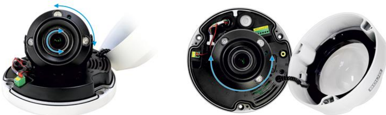
Рисунок 5.16 – Настройка направления объектива
