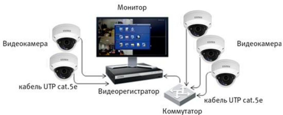
Рисунок 6.5 – Схема подключения видеокамеры к видеорегистратору
