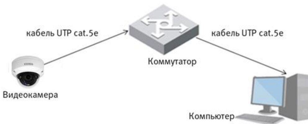
Рисунок 6.4 - Схема подключения видеокамеры к компьютеру через коммутатор
