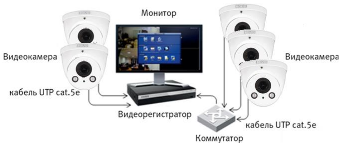
Рисунок 6.4 – Схема подключения видеокамеры к видеорегистратору
