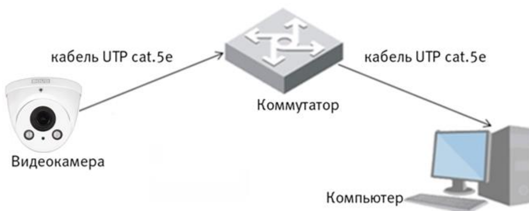
Рисунок 6.3 - Схема подключения видеокамеры к компьютеру через коммутатор
