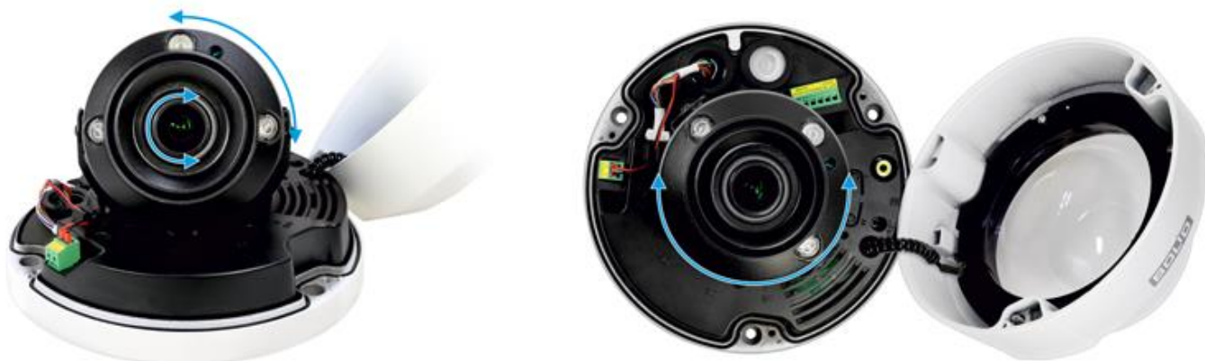
Рисунок 5.16 – Настройка направления объектива
