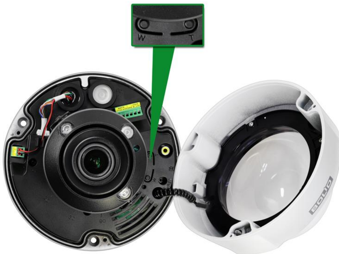
Рисунок 5.15 – Настройка фокусного расстояния вручную
