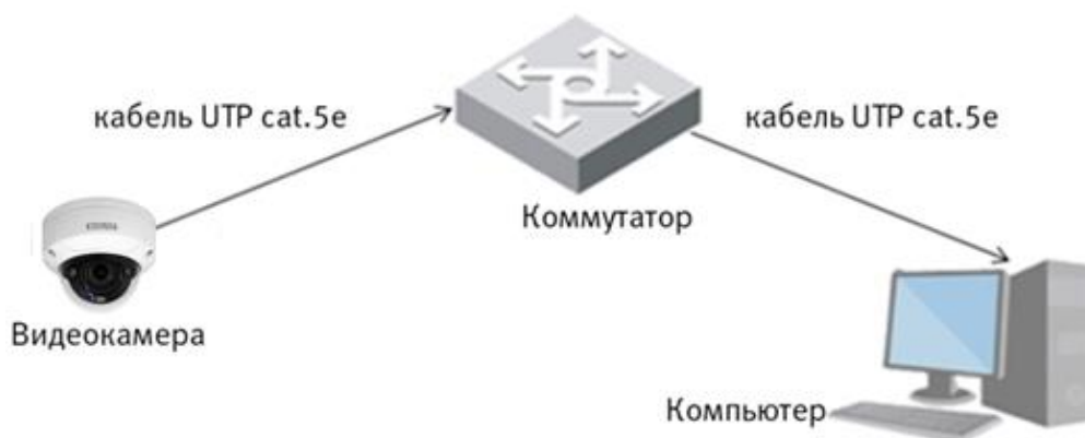
Рисунок 6.4 - Схема подключения видеокамеры к компьютеру через коммутатор
