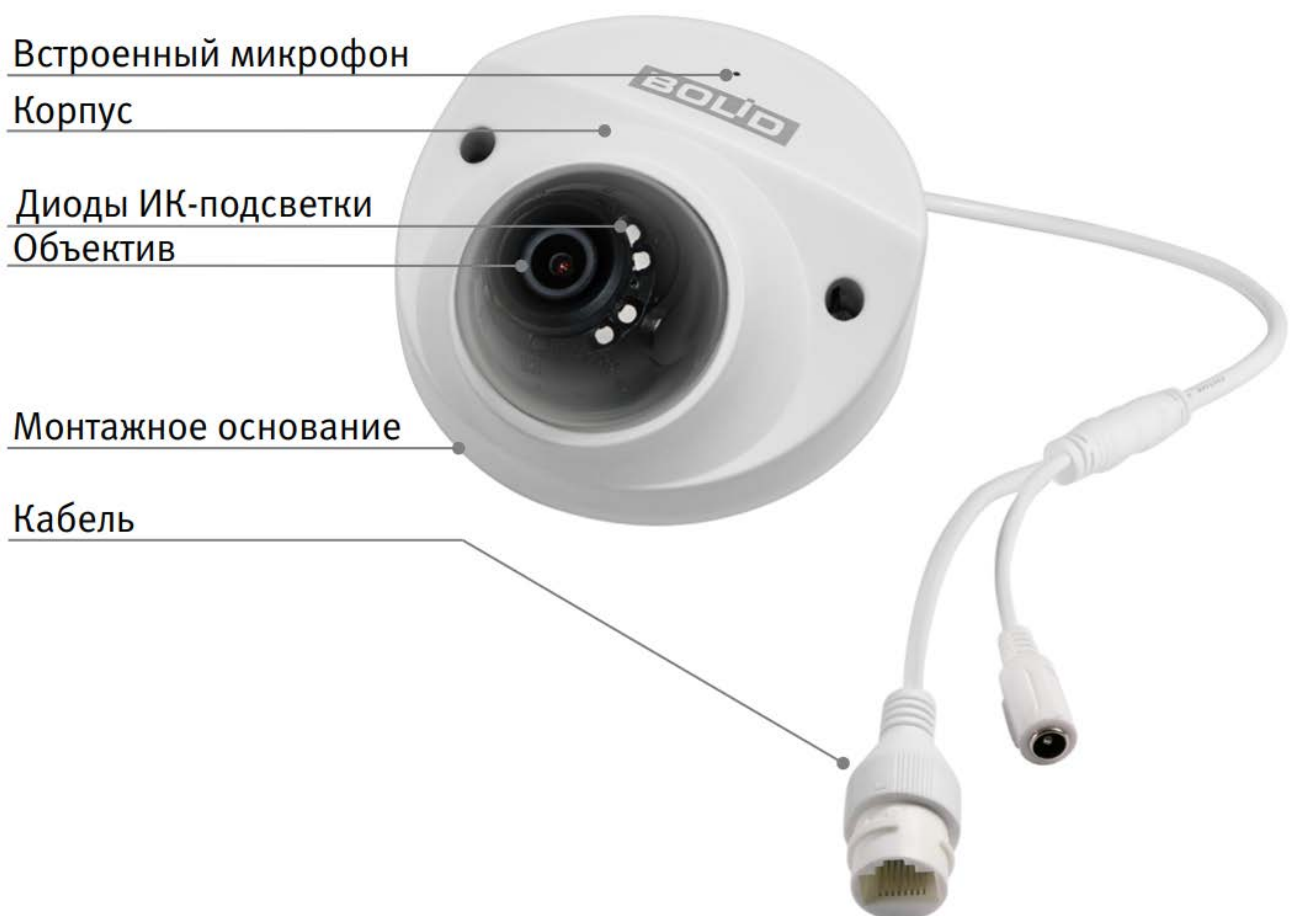
Рисунок 4.1 — Внешний вид и основные элементы видеокамеры
