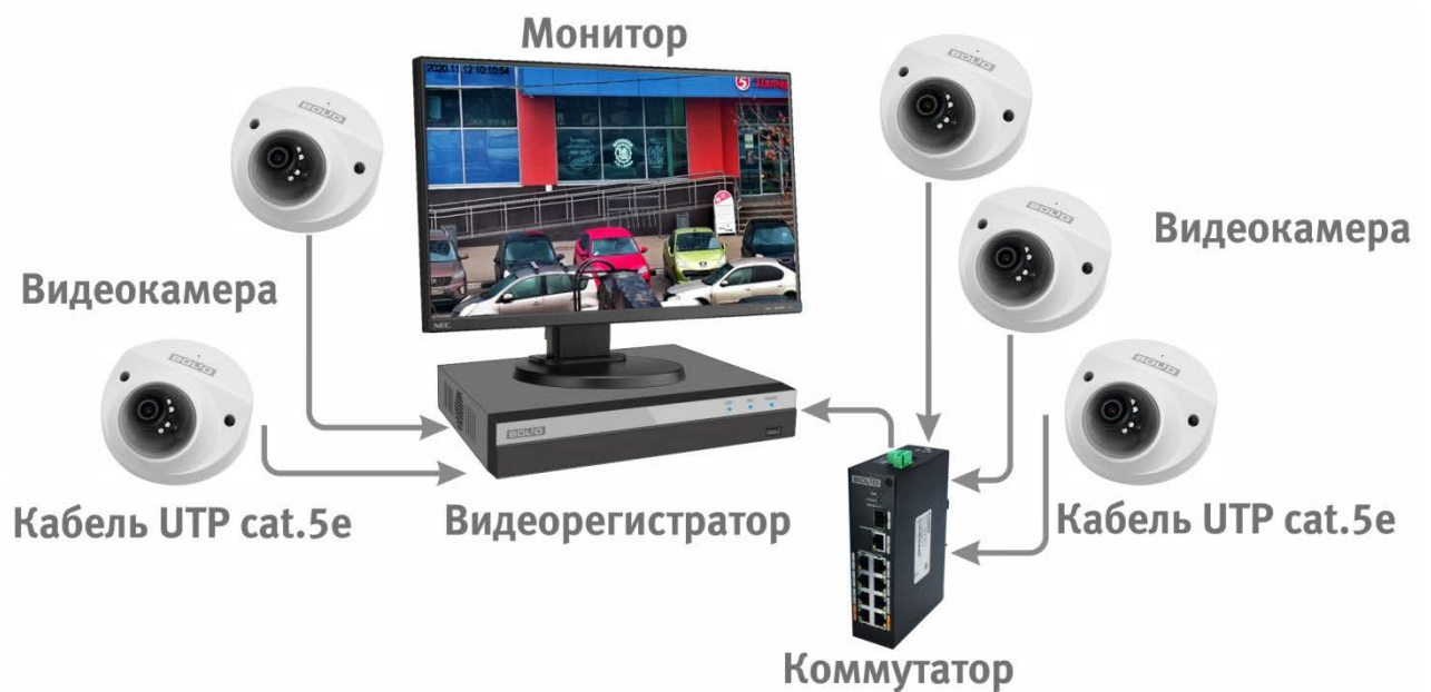
Рисунок 6.4 — Схема подключения видеокамеры к видеорегистратору
