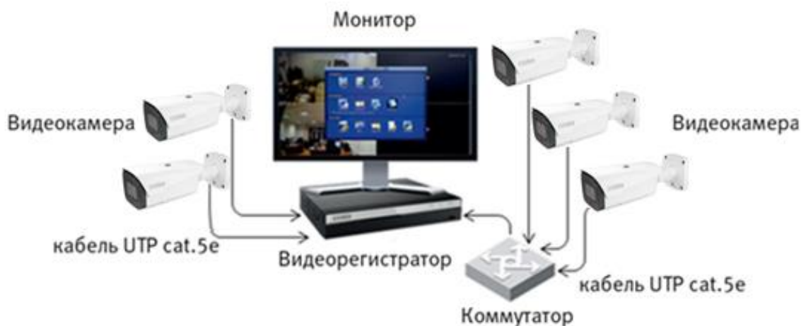
Рисунок 6.4 – Схема подключения видеокамеры к видеорегистратору
