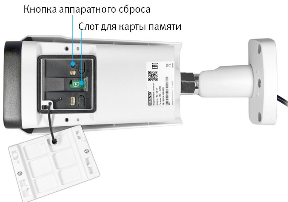
Рисунок 4.2 – Расположение кнопки аппаратного сброса и слота для карты памяти
