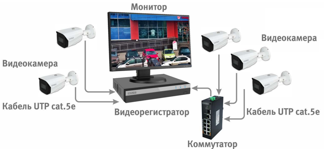
Рисунок 6.4 — Схема подключения видеокamеры к видеорегистратору
