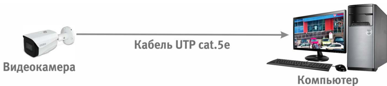
Рисунок 6.2 — Схема подключения видеокамеры к компьютеру
