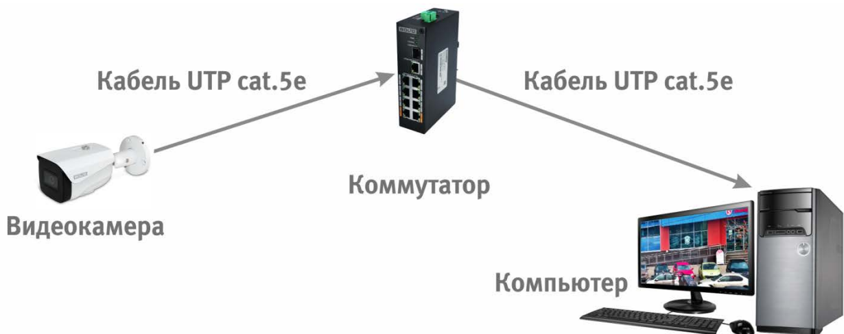
Рисунок 6.3 — Схема подключения видеокамеры к компьютеру через коммутатор
