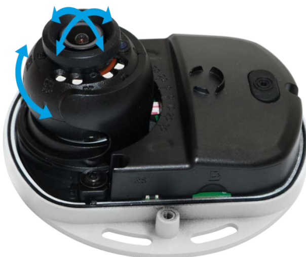
Рисунок 5.7 — Настройка направления объектива
