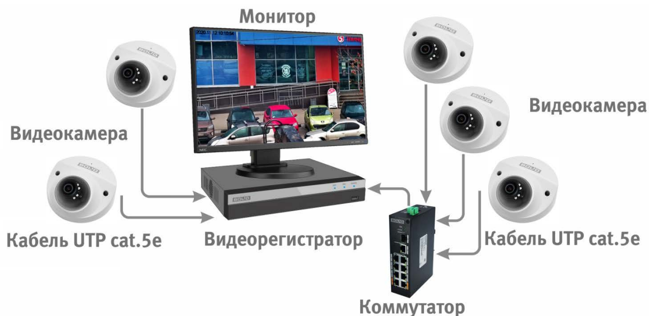
Рисунок 6.4 — Схема подключения видеокамеры к видеорегистратору
