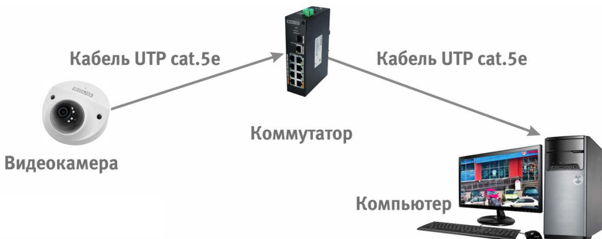
Рисунок 6.3 — Схема подключения видеокамеры к компьютеру через коммутатор
