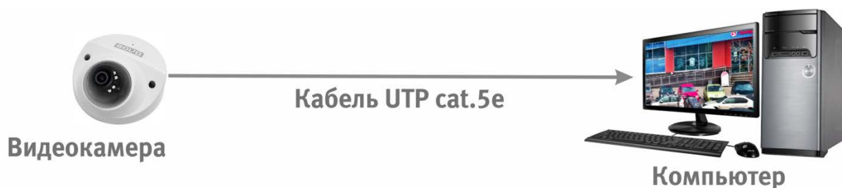
Рисунок 6.2 — Схема подключения видеокамеры к компьютеру
