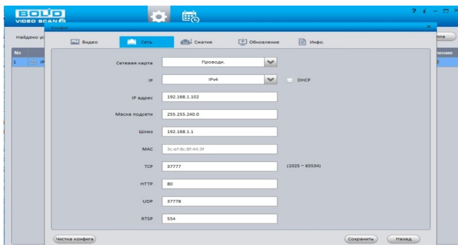
Рисунок 12.2 — Изменение IP-адреса видекамеры с помощью утилиты «BOLID VideoScan»
