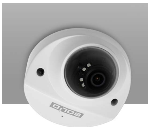
Рисунок 5.2 — Потолочное крепление видеокамеры
