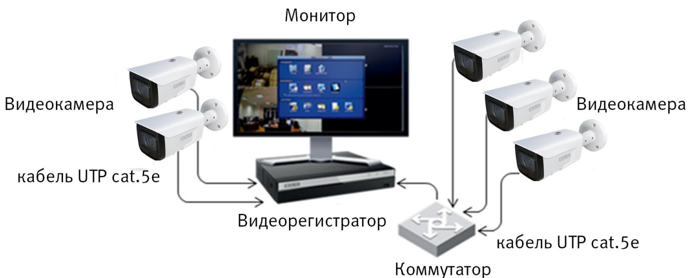
Рисунок 6.4 – Схема подключения видеокамеры к видеорегистратору
