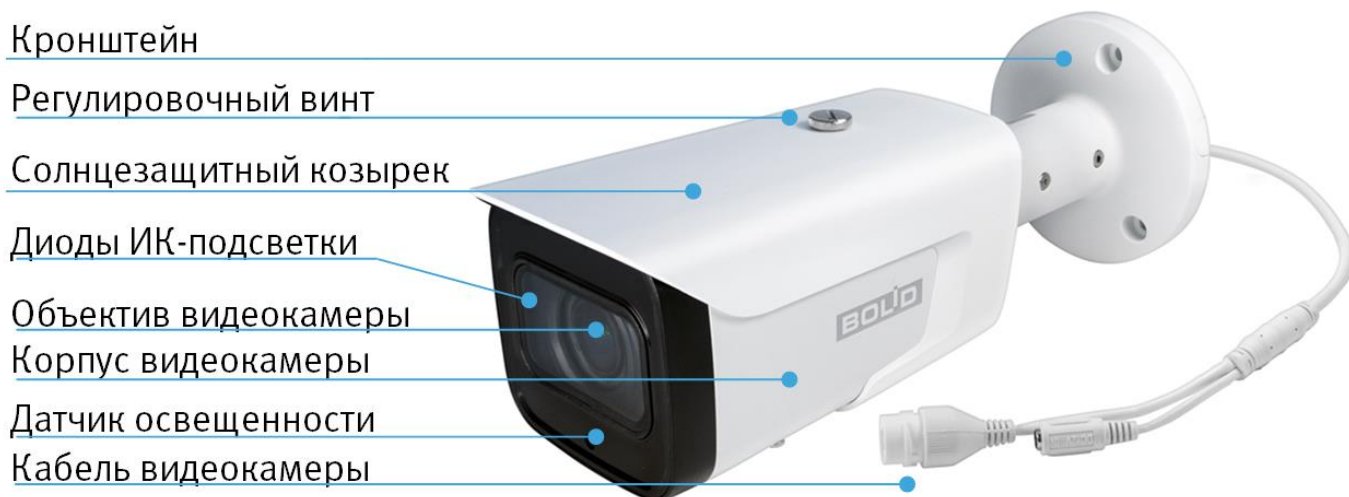
Рисунок 4.1 - Внешний вид и основные элементы видеокамеры
