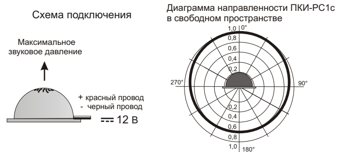
Рис.2 Схема подключения и диаграмма направленности звука оповещателя ПКИ-РС1с.
