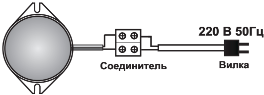
Рис.2 Схема подключения устройства “СБ-3”.
