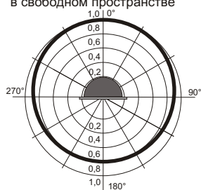
Рис.2 Схема подключения и диаграмма направленности оповещателя.
