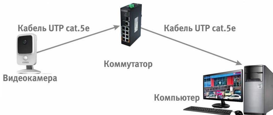
Рисунок 6.4 — Схема подключения видеокамеры к компьютеру через коммутатор
