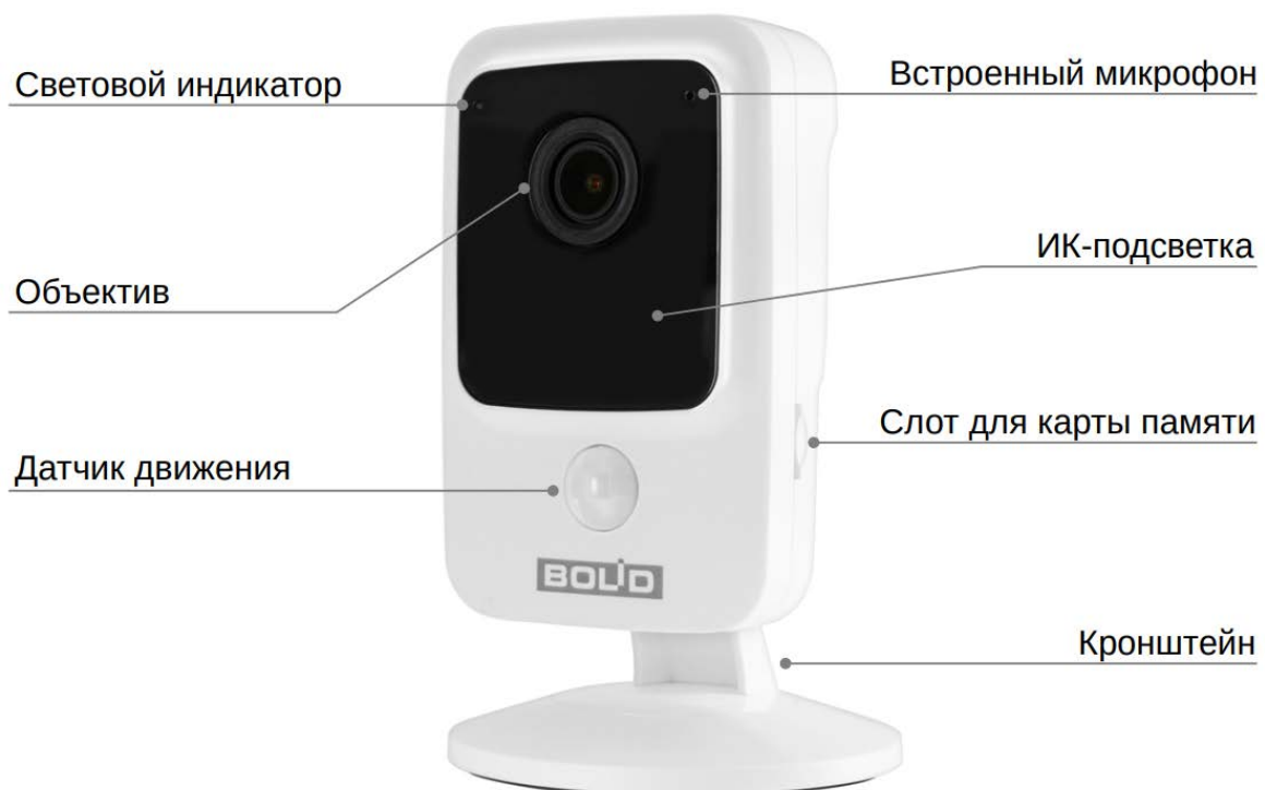
Рисунок 4.1 — Внешний вид и основные элементы видеокамеры
