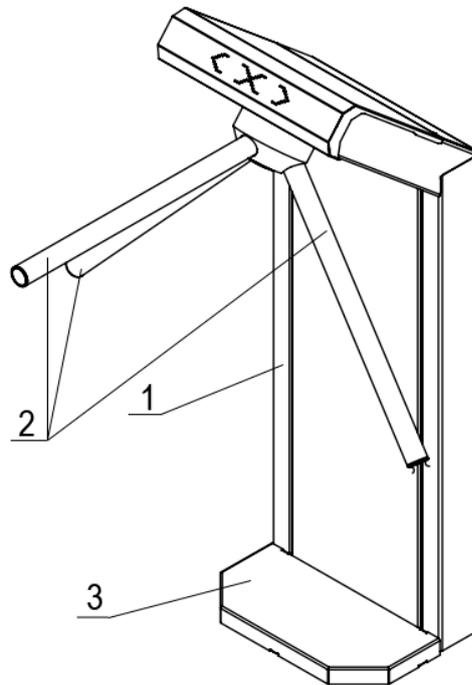
**Рисунок 1.2.4 – Турникет-трипод (напольный) «3V» «Model V» TO-07**
