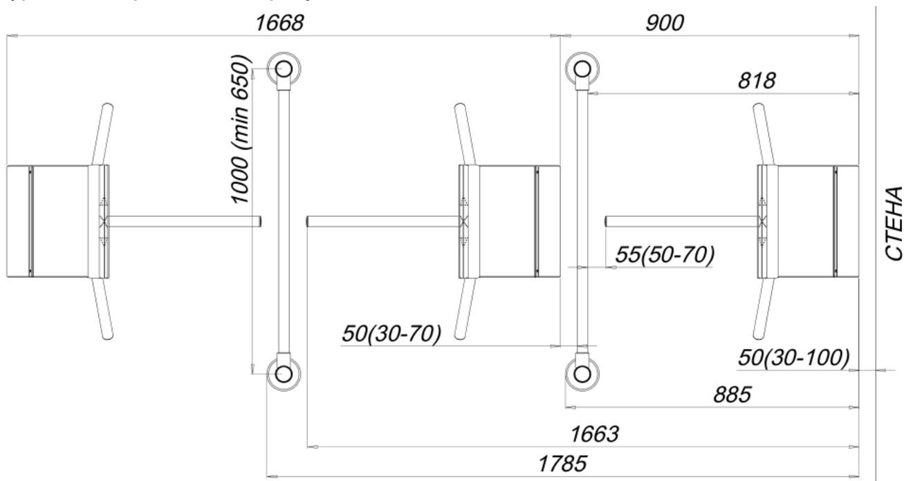
**Рисунок 4.3 – Размещение турникетов относительно ограждений (рекомендованные зазоры)**
