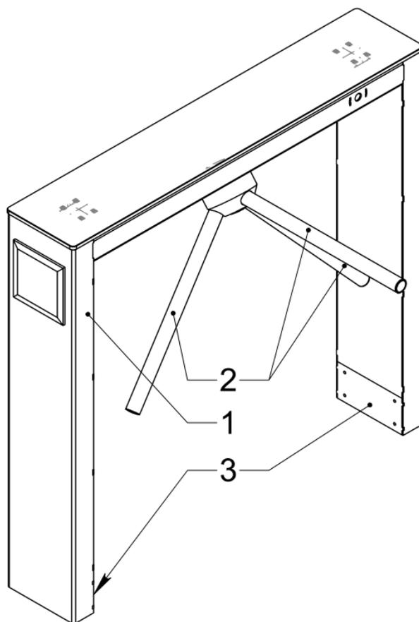
Рисунок 1.2.7 – Турникет-трипод тумбовый (напольный) «3V» «Model T» TT-01
