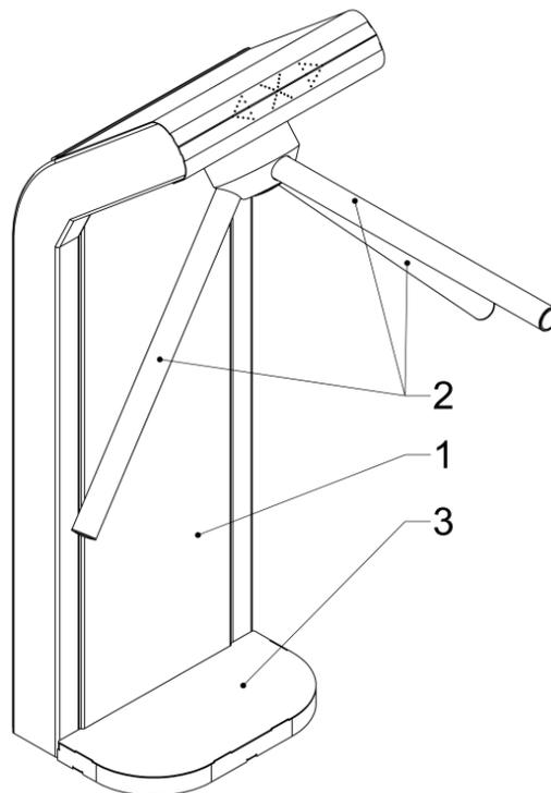
**Рисунок 1.2.5 – Турникет-трипод (напольный) «3V» «Model S» TO-07**
