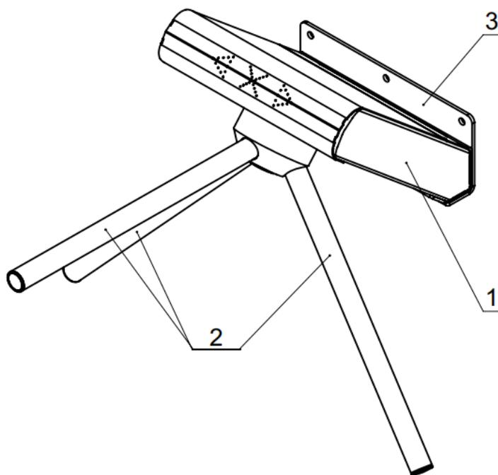
**Рисунок 1.2.7 – Турникет-трипод (настенный) «3V» «Model D» ТО-07**
