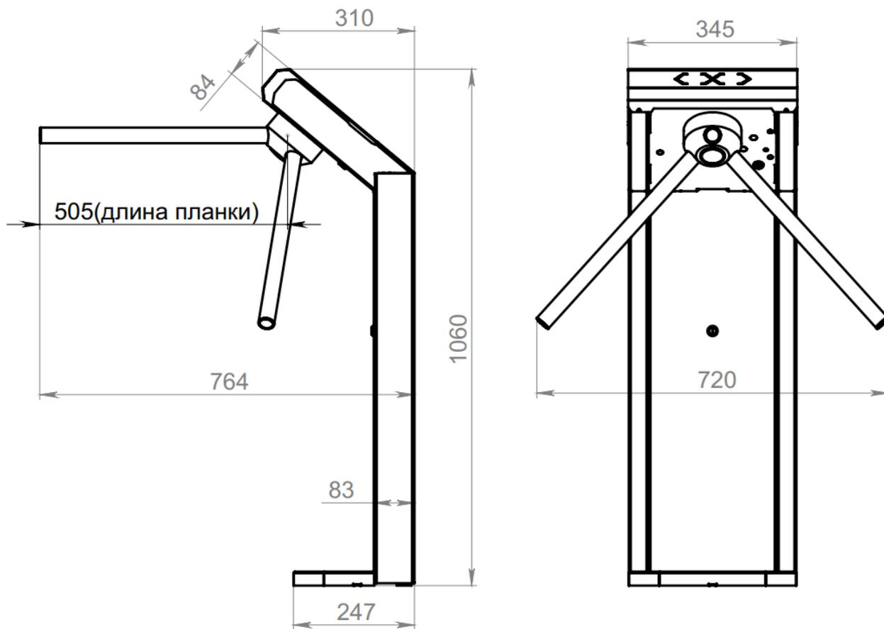
Рисунок 1.4.5 – Габаритные размеры турникета «Model V»
