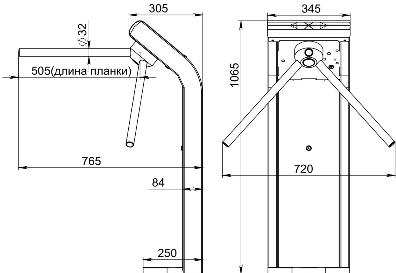
Рисунок 1.4.2 – Габаритные размеры турникета «Model S»
