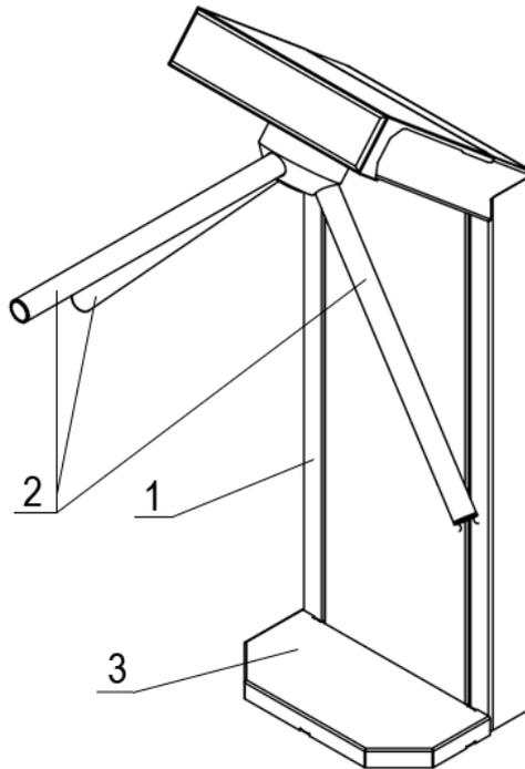
**Рисунок 1.2.3 – Турникет-трипод (напольный) «3V» «Model V (bg)» TO-07**
