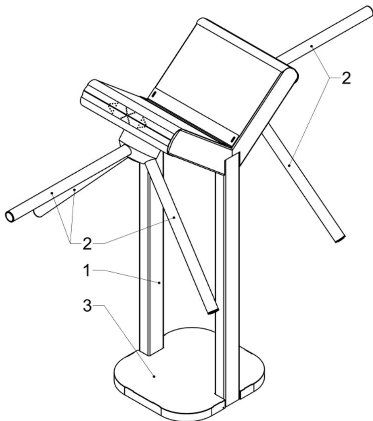
**Рисунок 1.2.6 – Турникет-трипод (напольный) двухпроходный «3V» «Model Y» ТД-07**
