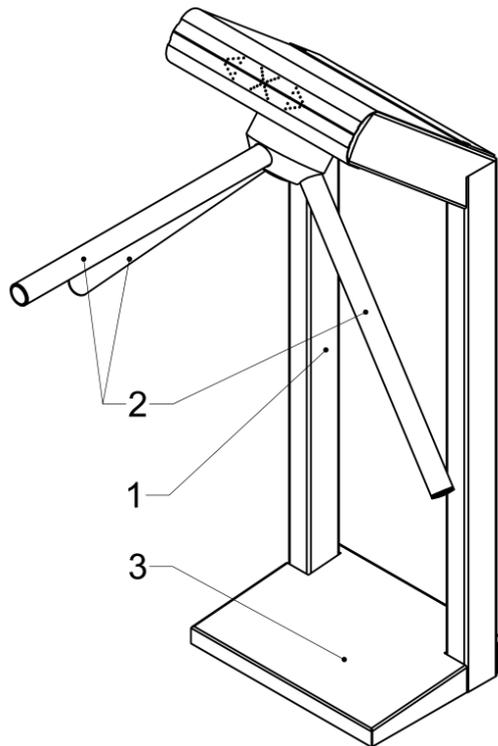
**Рисунок 1.2.1 – Турникет-трипод (напольный) «3V» «Model L» TO-07,
