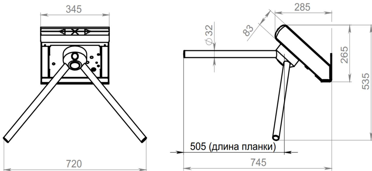
Рисунок 1.4.7 – Габаритные размеры турникета настенного «Model D»
