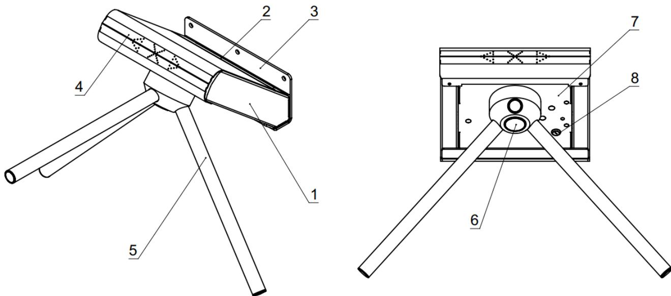
**Рисунок 1.5.2 – Составные части турникета «Model D»**
