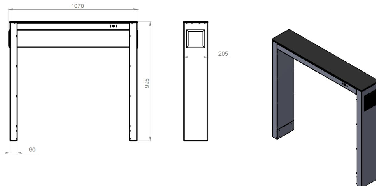
**Рисунок 1.4.8 – Габаритные размеры формирователя прохода тумбового**
