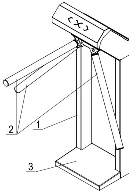
**Рисунок 1.2.2 – Турникет-трипод (напольный) «3V» «Model A» TO-07**
