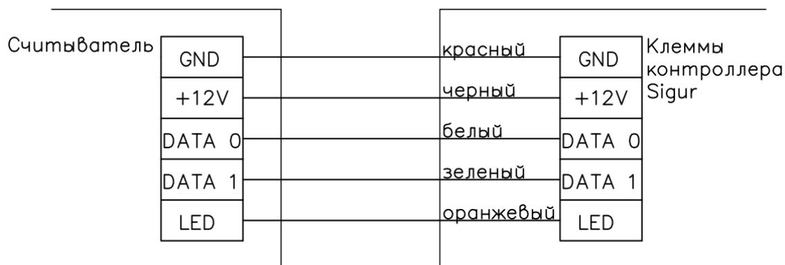
**Рисунок 3.3.3 – схема расключения считывателей турникетов на контроллер Sigur E500, Sigur E500U**
