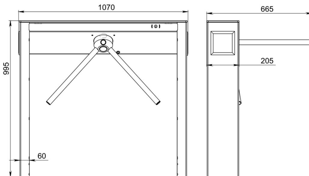
Рисунок 1.4.8 – Габаритные размеры турникета тумбового «Model T»
