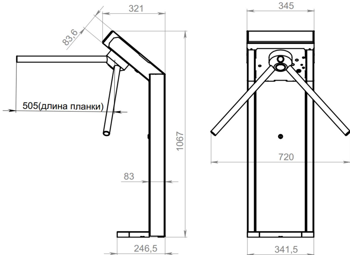
Рисунок 1.4.4 – Габаритные размеры турникета «Model V (bg)»
