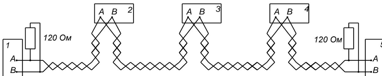
Рисунок 2.4.1 – Пример правильного подключения оборудования по RS485
