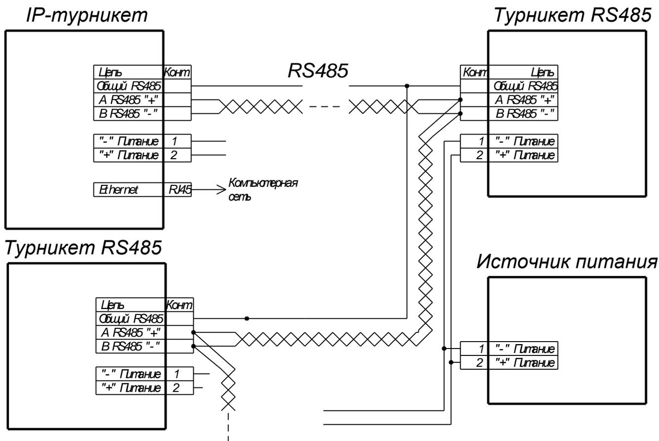
Рисунок 2.3.5 – Электрическая схема подключения интерфейса RS485
