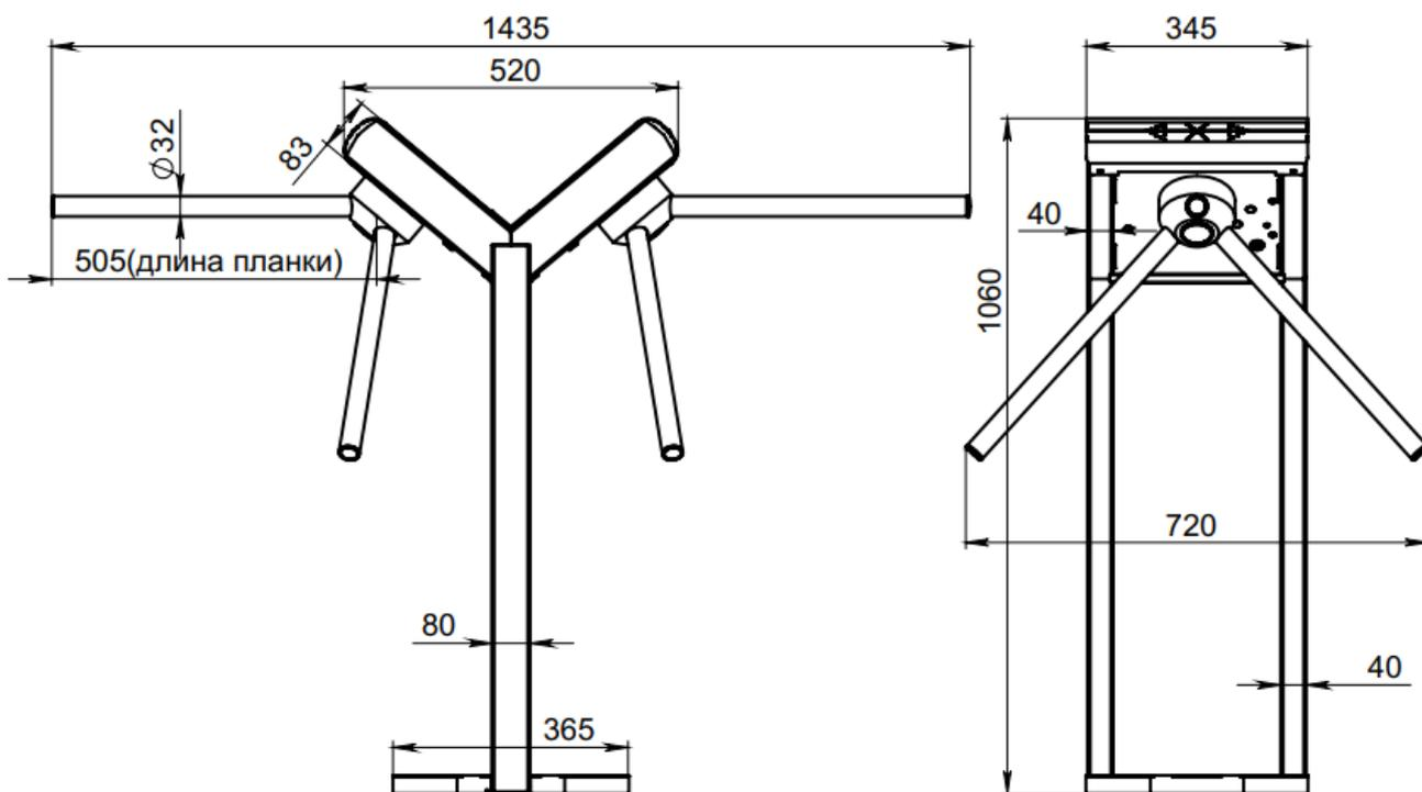
Рисунок 1.4.6 – Габаритные размеры турникета «Model Y»
