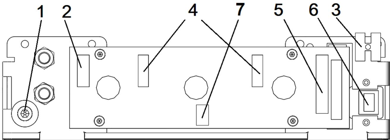
**Рисунок 2.3.3 – Подключение IP-турникетов (клеммы)**
