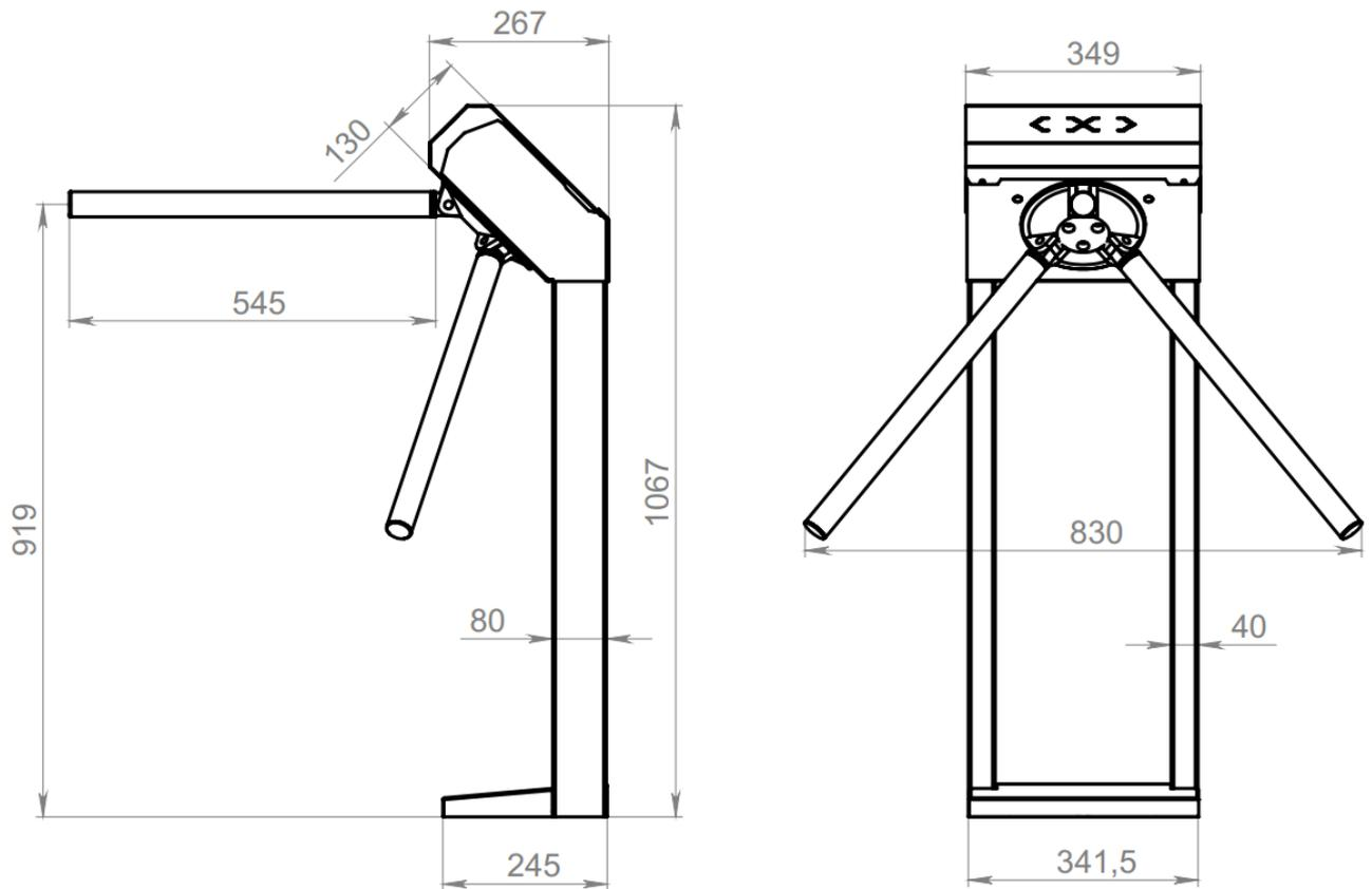
Рисунок 1.4.3 – Габаритные размеры турникета «Model A»
