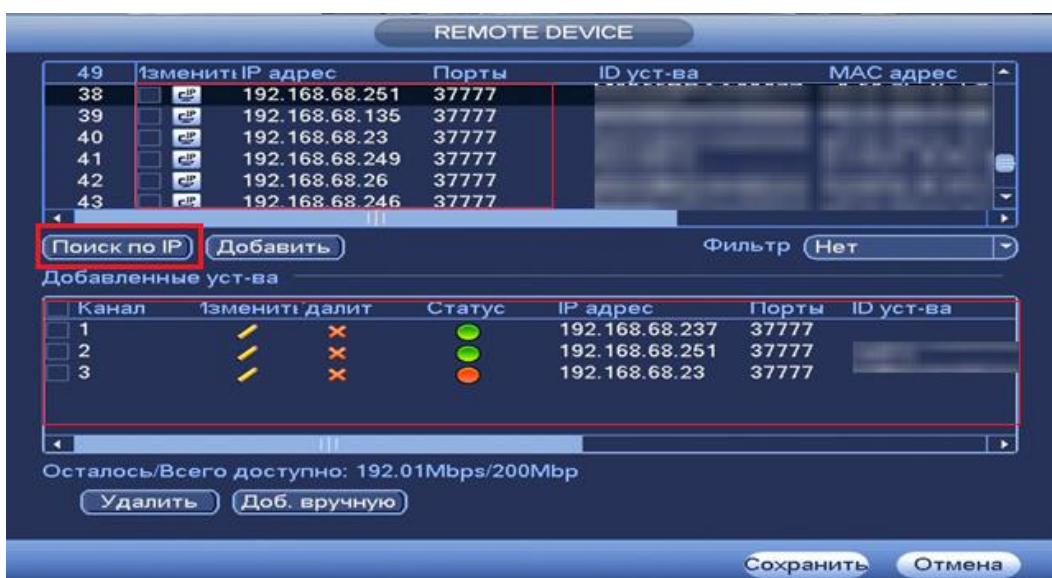
Рисунок 7.31 Настройка добавления камер по поиску в сети.
