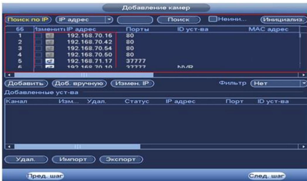
Рисунок 6.10 Настройка добавления камер по поиску в сети.
