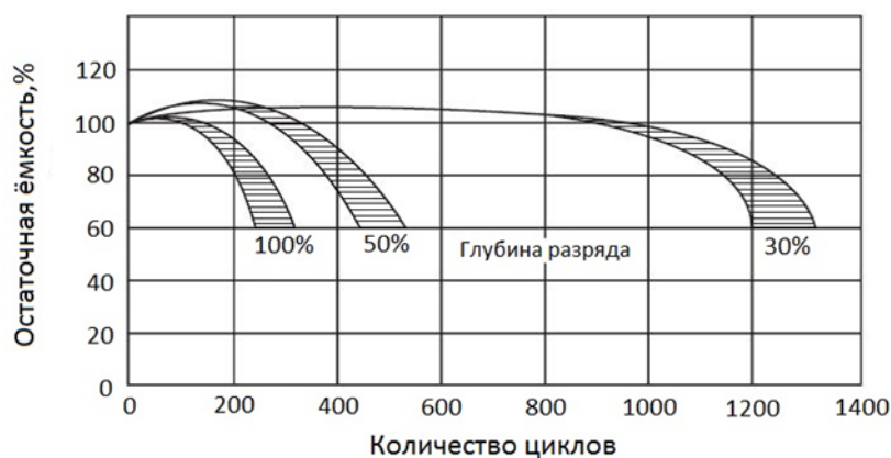
Рис. 8. Зависимость количества циклов от глубины разряда аккумуляторов серии «Болид».
