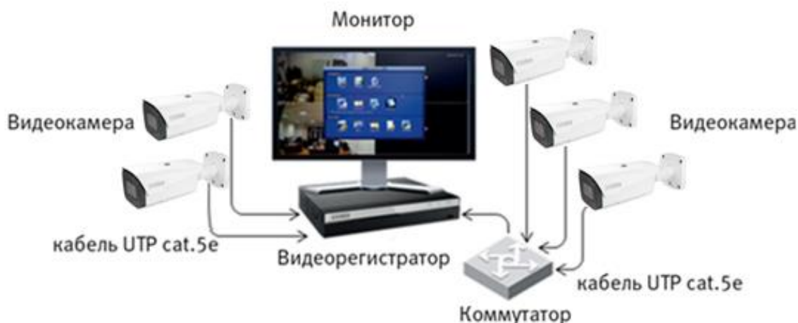
Рисунок 6.4 – Схема подключения видеокамеры к видеорегистратору
