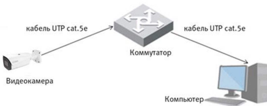
Рисунок 6.3 - Схема подключения видеокамеры к компьютеру через коммутатор
