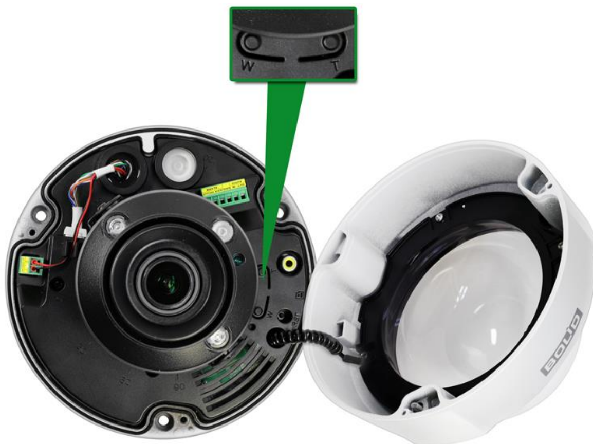
Рисунок 5.15 – Настройка фокусного расстояния вручную
