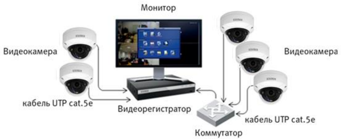
Рисунок 6.5 – Схема подключения видеокамеры к видеорегистратору
