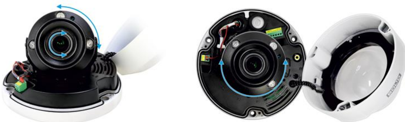
Рисунок 5.16 – Настройка направления объектива
