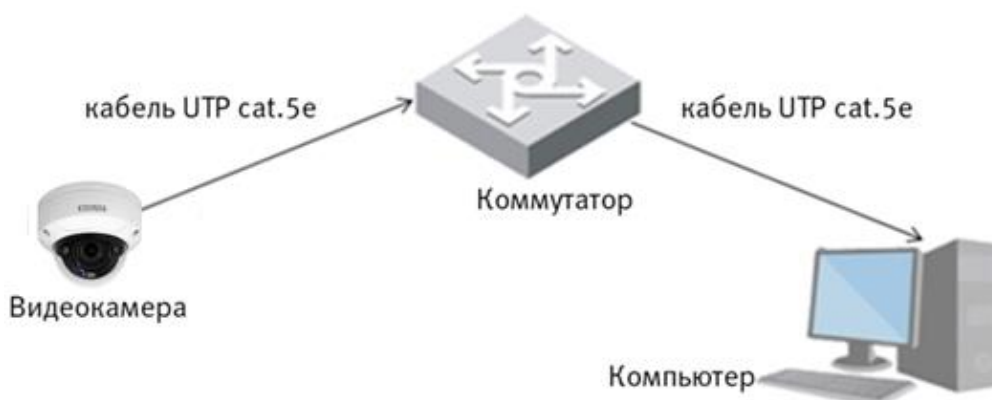
Рисунок 6.4 - Схема подключения видеокамеры к компьютеру через коммутатор
