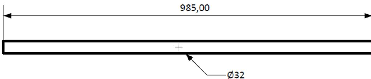
Поручень диаметром 32 мм и длиной 985 мм. Материал - нержавеющая сталь AISI 201.
