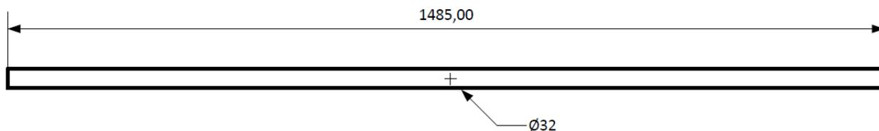
Поручень диаметром 32 мм и длиной 1485 мм. Материал - нержавеющая сталь AISI 201.
