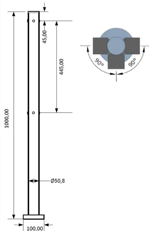
**2. TSb-VK** - Стойка универсальная трехсторонняя, с шестью отверстиями для крепления муфт TSb-M, TSb-MK и отверстием для фиксатора поворотной створки TSb-K
