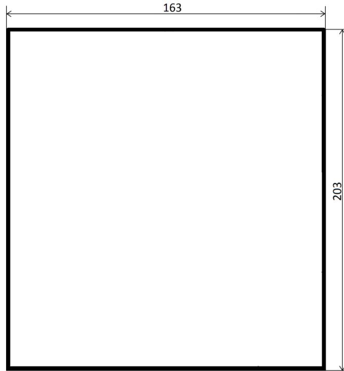
2) Установочные размеры РИП-12 исп.100 (РИП-12-3/7М6-В1) по задней стенке корпуса
