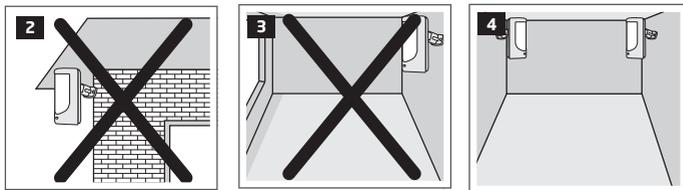
Для избежания ложных сработок, не устанавливайте датчики в следующих местах:
