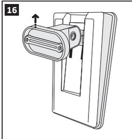
**ВНИМАНИЕ:** Убедитесь в том, что держатель надежно закреплен в устройстве, в противном случае задняя кнопка тампера не сможет корректно функционировать. Если не собираетесь использовать заднюю кнопку тампера, пожалуйста отключите ее, установив перемычку на контакты DIS-TAMP2 (см. раздел **2.2 Назначение Контактв и Светодиодов LED** для более подробной информации).
