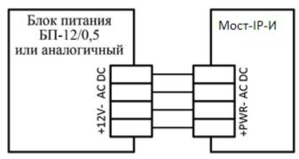
Для питания устройства возможно использование резервированного блока питания "БП-12/0,5" производства "Аргус-Спектр" с несущей панелью, позволяющей закрепить прибор непосредственно на блоке питания и выполнить все соединения внутри корпуса.
