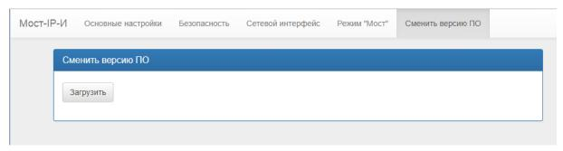
Нажмите кнопку «Загрузить» и выберите файл прошивки (firmwareX.Y.Z.tar.gz, где X.Y.Z – номер версии ПО).
