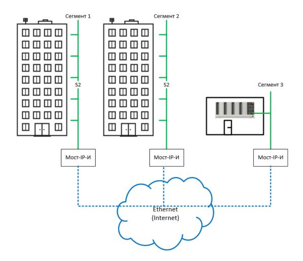
Возьмем за основу систему, рассмотренную в п. 5.4.3. Добавим сегмент 3 в который подключим БУ32-И для отображения состояния глобальной группы разделов 1.
