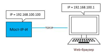
В сетевых настройках ПК необходимо указать IP-адрес: **192.168.100.1**, Маска подсети **255.255.25.0**. После этого прибор будет доступен из Web-браузера (Firefox, Chrome, Opera, Safari) по адресу 192.168.100.100.
