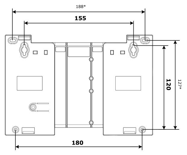
После навешивания Мост-IP-И закрепляется на стене путём вкручивания одного либо двух дополнительных шурупов.
