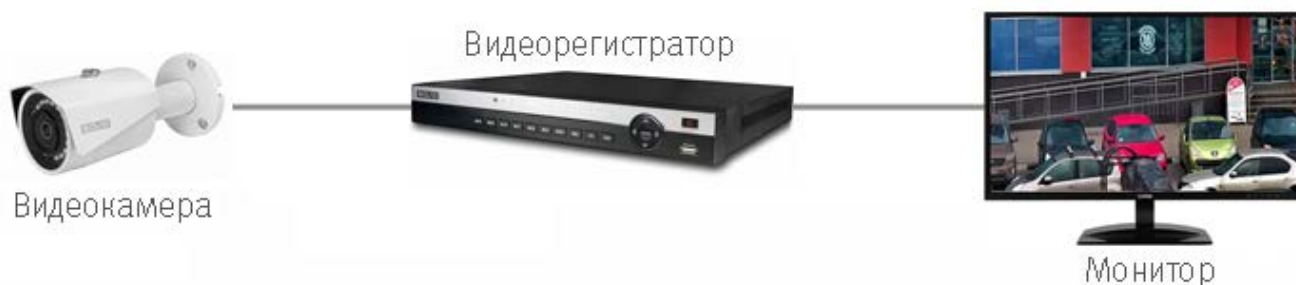
Рисунок 6.2 — Схема подключения видеокамеры
