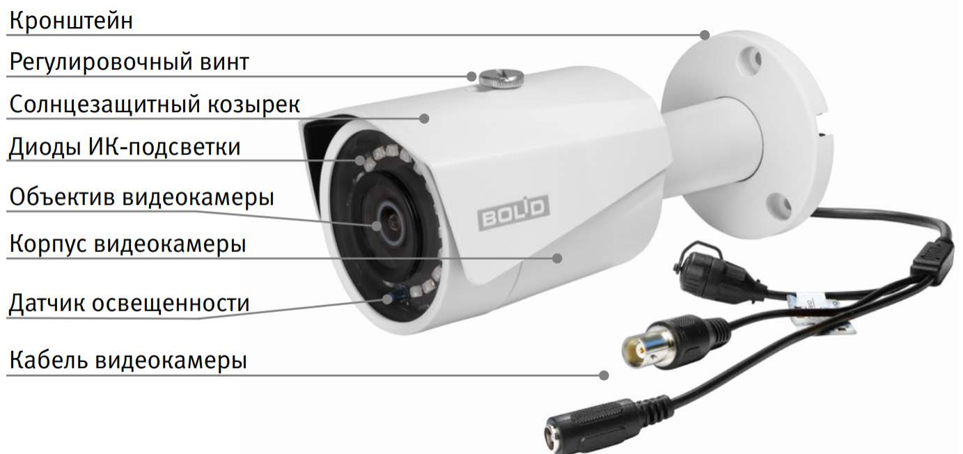
Рисунок 4.1 — Внешний вид и основные элементы видеокамеры
