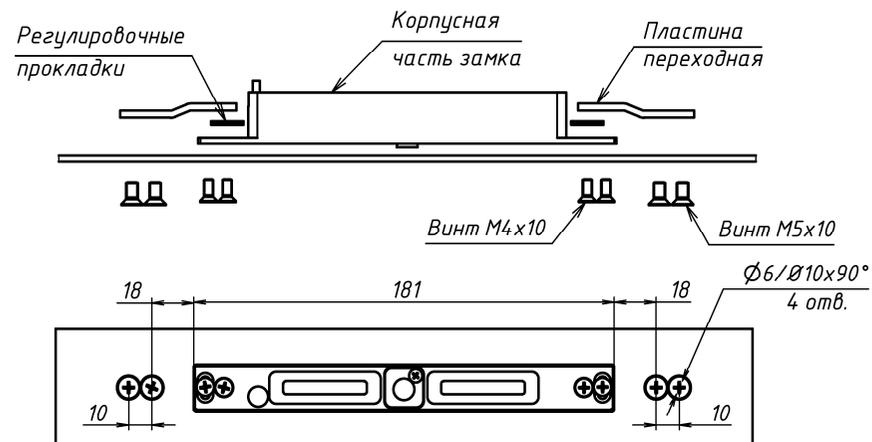
Рисунок 8 – Установка корпуса для металлической двери
