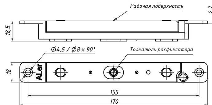
Рисунок 5 - Якорная часть замка AL-250SM
