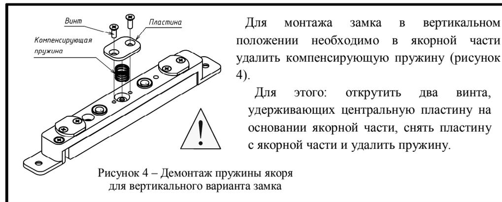
Рисунок 4 – Демонтаж пружины якоря для вертикального варианта замка
