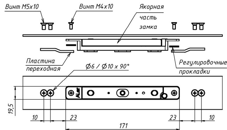
Рисунок 9 – Установка якоря на металлическую дверь
