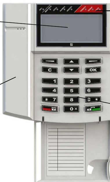
Для снятия крышки отсека подключений необходимо использовать отвёртку.
