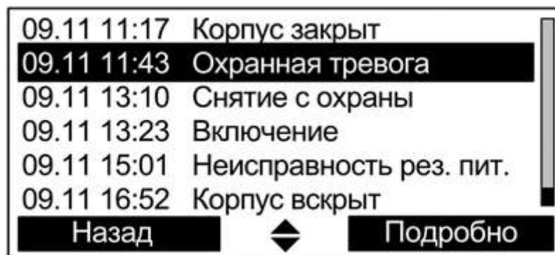
При нажатии экранной клавиши **«Подробнее»** открывается окно с детальным описанием события, включающим дату, время и место события, а также дополнительную информацию в зависимости от типа события. Номера раздела и устройства сопровождаются текстовыми описаниями (при наличии).
