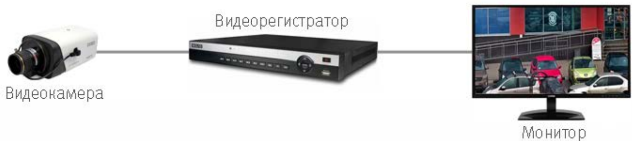
Рисунок 8.2 — Схема подключения видеокамеры
