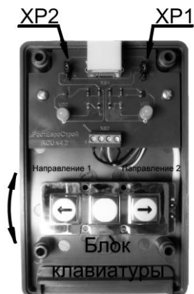
Вид пульта со снятой крышкой
