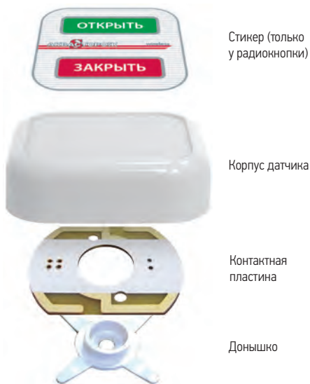
Составные части радиодатчика
