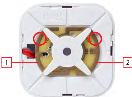
Замыкание контактов 1 и 2 для прописки датчиков
