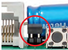
Джампер установлен = активный режим
