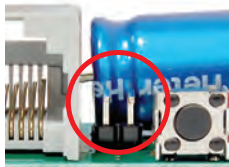
Джампер удален = энергосберегающий режим
