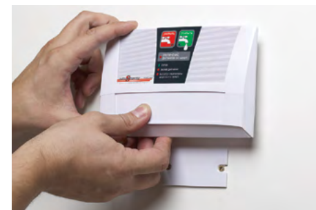
Вставить контроллер в пластину.
