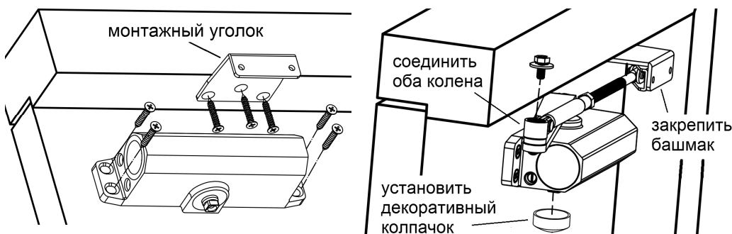
Рисунок 5 – Вариант параллельной установки при помощи монтажного уголка.
