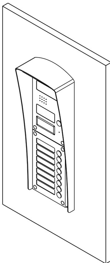
**Расположение блока вызова и кнопочной панели в монтажном комплекте**
