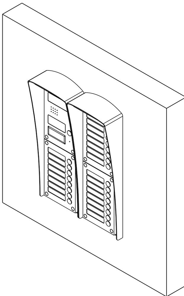
Расположение блока вызова и кнопочных панелей в монтажных комплектах
