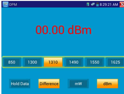
Рис. 3.3.12-1 Измерение относительной оптической мощности
