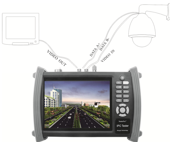
Рис.3.2.2-1 Подключение к тестеру PTZ-камеры и монитора.
