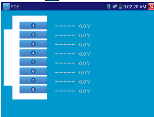
Рис. 3.3.18-1 Напряжение PoE на линиях кабеля витой пары
