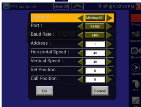
Рис.3.3.1-2 Окно настройки протокола управления камерой (RS485)
