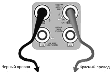
Рис.3.1-1 Подключение измерительного щупа к тестеру.
