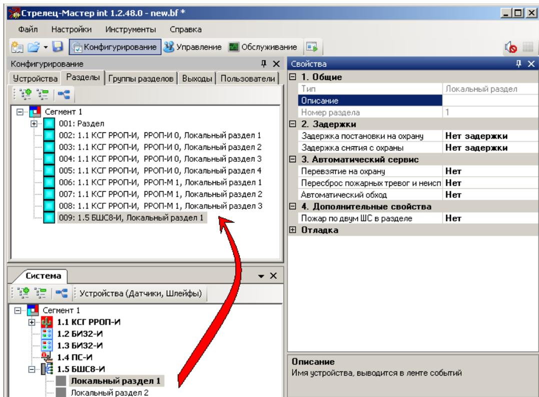
4. Зарегистрировать необходимые реле БШС в качестве выходов сегментной логики ИСБ, перетянув их в окне программы на вкладке "Конфигурирование. Выходы" из нижней части окна в верхнюю:
