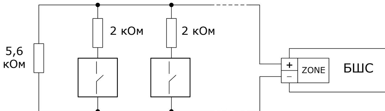
**4. Подключение нормально замкнутых пожарных извещателей с выходом типа "сухой контакт"** (тип ШС - пожарный тепловой, с распознаванием или без распознавания сработки двух извещателей):
