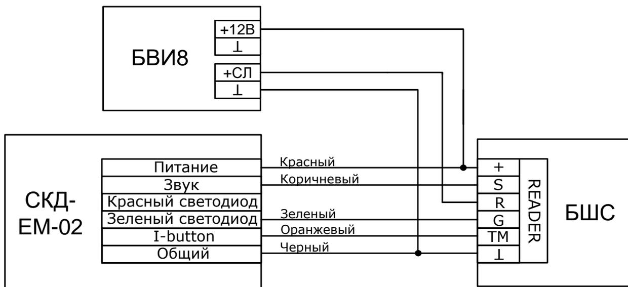
Режим индикации считывателя при конфигурировании БШС должен быть сконфигурирован, как "Proximity", тип индикации должен быть установлен – "БВИ8 (разделы)" или "БВИ8 (ШС)".
