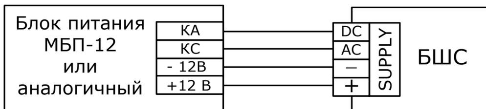
При использовании блока питания без выходных сигналов о состоянии сетевого и резервного источников питания возможно отключить контроль линий AC и DC при конфигурировании БШС, либо соединить цепь контроля AC БШС с положительной клеммой питания, установив переключку "AC", находящуюся на печатной плате БШС.
