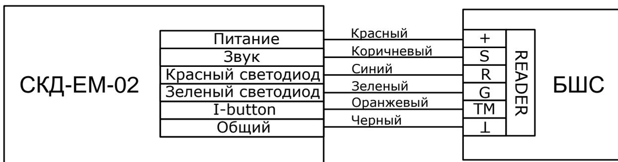
Режим индикации считывателя при конфигурировании БШС должен быть сконфигурирован, как "Proximity", тип индикации должен быть установлен – "СО".
