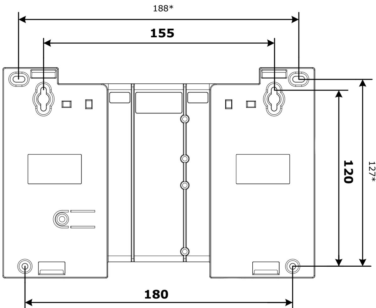
\* Размеры дополнительных отверстий.
