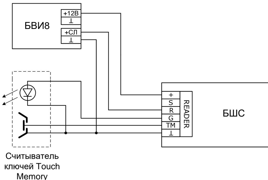
Режим индикации считывателя при конфигурировании БШС должен быть сконфигурирован, как "Touch Memory". Индикатор считывателя в этом случае отображает обобщенное состояние списка локальных разделов БШС.
