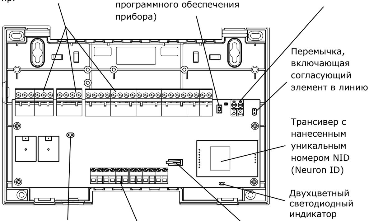
Перемычка "АС" (соединяет вход "АС" и положительную клемму питания прибора)
