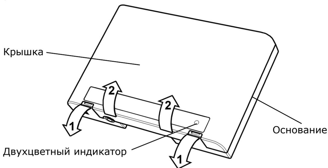
Для того, чтобы закрыть корпус прибора, необходимо сначала зацепить крышку за основание сверху, а потом полностью закрыть прибор
