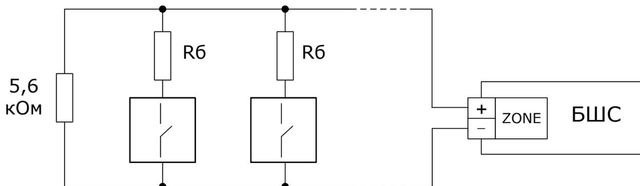
Балластные резисторы  $R_b$  для подключения извещателей типа "Аврора-ДН" должны иметь сопротивление 1 кОм:
