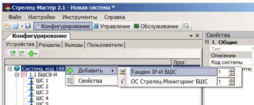
Для добавленного устройства следует определить события БШС, подлежащие передаче на пульт централизованного наблюдения, разделы, информацию о событиях в которых необходимо передавать, а также другие опции устройства в зависимости от его типа.
