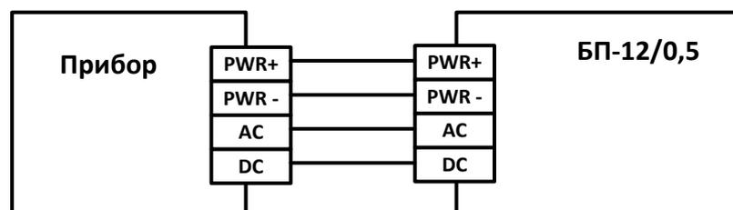
Для обеспечения **двух вводов** питания допускается включение двух внешних блоков питания по следующей схеме:
