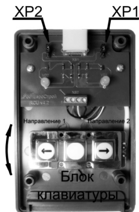
Вид пульта со снятой крышкой
