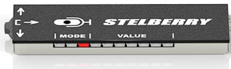
В этом режиме можно отрегулировать чувствительность микрофона. Для входа в режим необходимо нажимать на джойстик, чтобы в индикации режима MODE появилась следующая комбинация **○○●**
