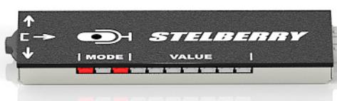
В этом режиме можно ослабить высокие частоты до 20 дБ (до 10 раз), вплоть до 3кГц. Для входа в режим необходимо нажимать на джойстик, чтобы в индикации режима MODE появилась следующая комбинация **●○●**
