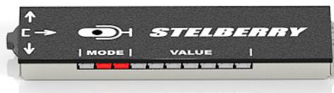
Выходная АРУ отключена. В зоне индикации VALUE не светится ни один светодиод.
